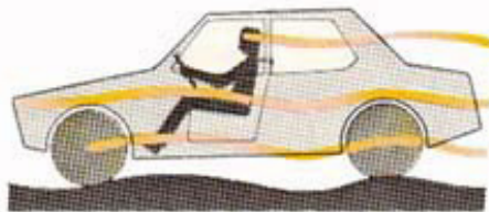
AUSÊNCIA DE SUSPENSÃO Todas as irregularidades da superfície da faixa de rodagem são transmitidas aos ocupantes do automóvel.
