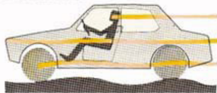
SUSPENSÃO EFICIENTE As rodas movem-se facilmente para cima e para baixo; porém, graças às molas e aos amortecedores, os ocupantes do automóvel não sentem esses movimentos.
