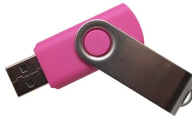
O pendrive é um dispositivo de armazenamento portátil, baseado em memória flash. Ele é muito usado por sua praticidade, sendo pequeno, leve e fácil de transportar. A capacidade dos pendrives varia de alguns megabytes (MB) a várias centenas de gigabytes (GB). Sua principal vantagem é a facilidade de uso, bastando conectá-lo a uma porta USB para acessar os dados.
