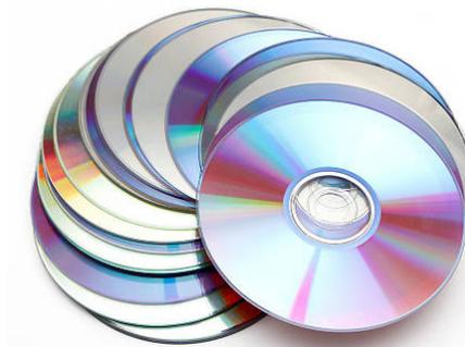
Os discos ópticos, como CDs, DVDs e Blu-rays, armazenam dados de forma óptica, utilizando um feixe de laser para ler e gravar as informações. Eles foram muito populares nas décadas passadas, principalmente para armazenar músicas, filmes e softwares, mas o uso desses dispositivos tem diminuído devido à popularidade de tecnologias como armazenamento em nuvem e memórias flash. No entanto, eles ainda são utilizados em nichos específicos, como na indústria cinematográfica e em backups de longo prazo.
