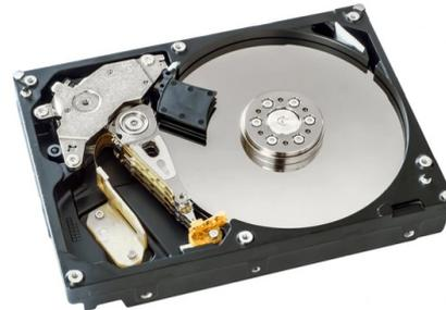
O disco rígido é um dispositivo de armazenamento não volátil, ou seja, mantém os dados mesmo quando o computador é desligado. Ele usa discos magnéticos para armazenar as informações. Atualmente, os HDs podem ter capacidades que variam de alguns gigabytes (GB) a vários terabytes (TB), e seu desempenho é medido pela velocidade de rotação dos discos, normalmente entre 5.400 e 7.200 rotações por minuto (RPM).
