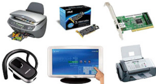
– Periféricos de entrada e saída: Dispositivos que podem receber dados do computador e enviar dados para ele, como drives de disco, monitores touchscreen e modems.
